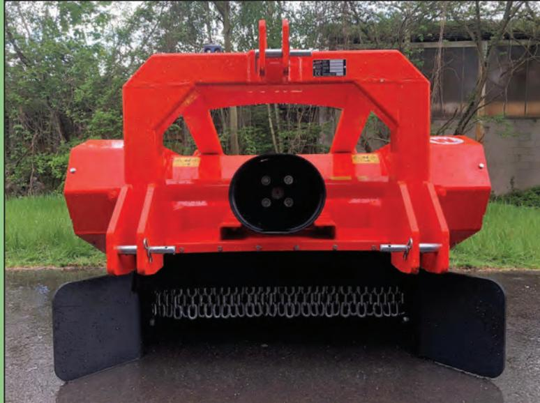
LIPA-Mulchgerätetechnik (WILLIBALD Lizenz) bietet mit dem Steinzerkleinerer TSL eine Maschine für den Einsatz auf sehr steinigem Böden. Die Maschine zerkleinert Steine bis zu einem Durchmesser von ca. 30 cm.
