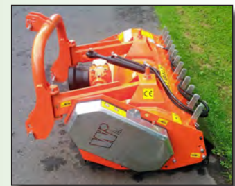
Geringere Bauhöhe durch schrägliegenden Keilriemenantrieb
