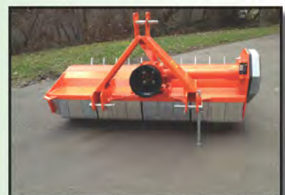
Schrägliegender Keilriemenantrieb, dadurch geringere Bauhöhe
