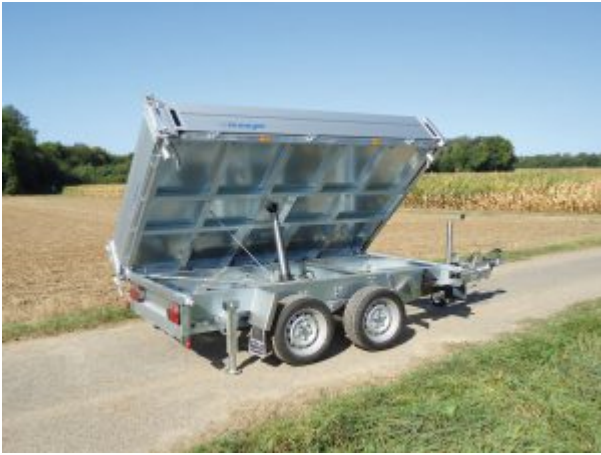
HKCR 2731-186 mit E-Pumpe und Stahlgitteraufsatz © WM Meyer
