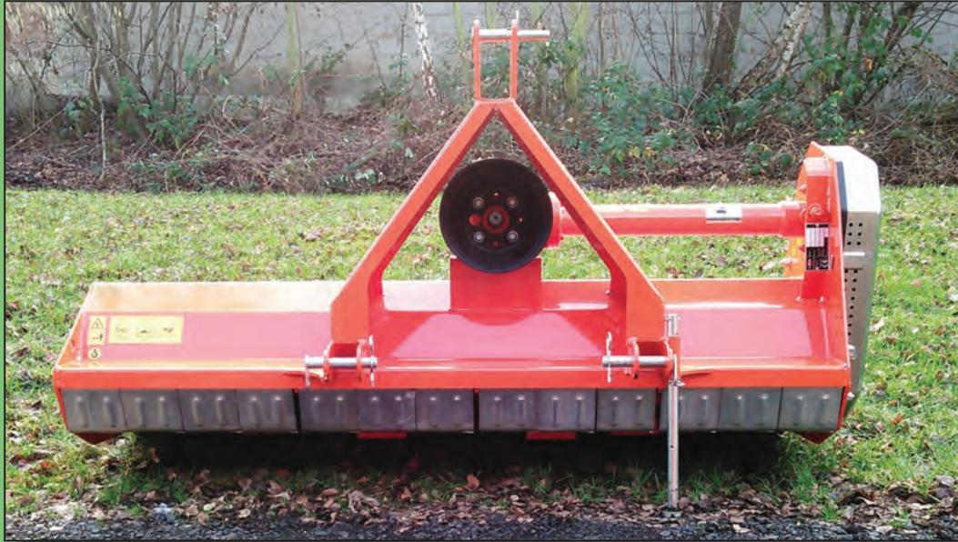
LIPA-Mulchgerätetechnik (WILLIBALD Lizenz) bietet eine intensive Zerkleinerung des Mulchgutes bei geringem Kraftbedarf.
