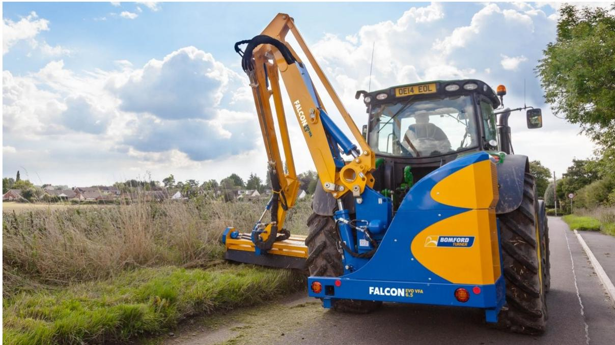
**Die robusten Falcon-Modelle eignen sich für den professionellen Einsatz z.B. bei Lohnunternehmen. Ausführung mit variablem Parallelarm für eine optimale Sicht auf den Mulchkopf während des Arbeitens. Fester Achsanbau am Schlepper.**
