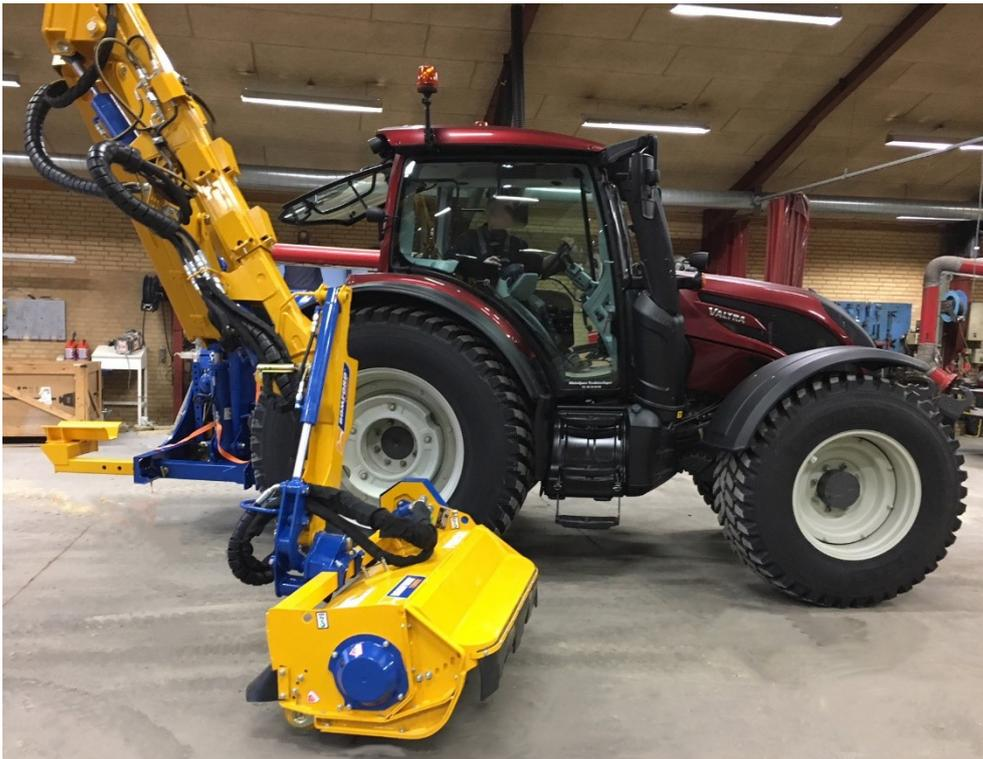
**Die robusten Falcon-Modelle eignen sich für den professionellen Einsatz z.B. bei Lohnunternehmen. Ausführung mit variablem Teleskop-Parallelarm für eine optimale Sicht auf den Mulchkopf während des Arbeitens. Fester Achsanbau am Schlepper.**
