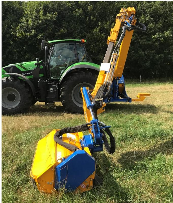
Die robusten Buzzard-Modelle eignen sich für den professionellen Einsatz z.B. bei Lohnunternehmen. Ausführung mit variablem Teleskop-Parallelarm für eine optimale Sicht auf den Mulchkopf während des Arbeitens. Fester Achsanbau am Schlepper.
