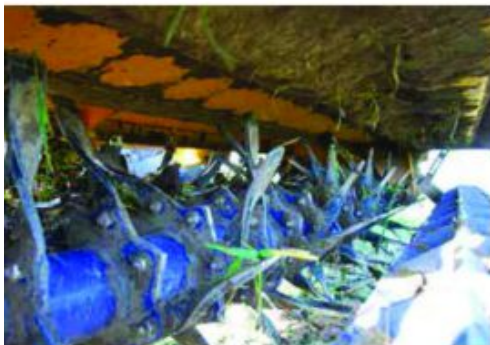
Die vordere Welle treibt die hintere mit dreifacher Geschwindigkeit an.
