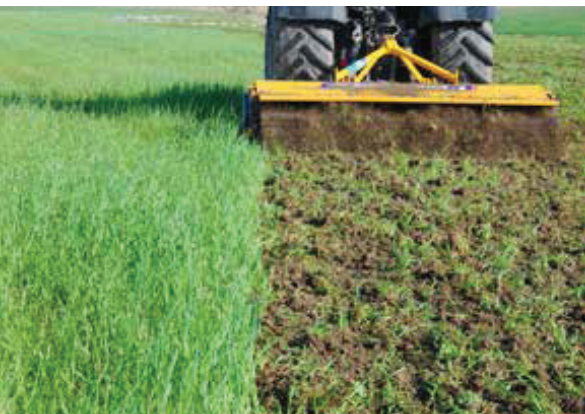
Die Rotoren verarbeiten sogar im Saft stehende Winterbegrünungen ordentlich.
